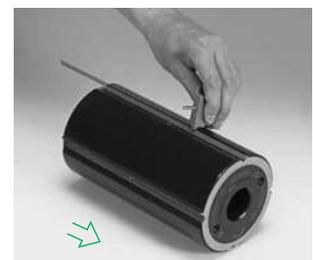
L'inserimento del coltello è facilitato da un accessorio di montaggio in serito tra tra la testa ed il cuneo di bloccaggio
