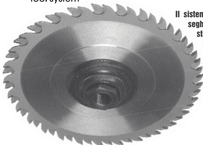
Il sistema Quickstep di regolazione per lame incisori è adatto per seghe circolari con gruppo incisore. L'attrezzaggio di macchine esistenti non presenta problemi. Il sistema è manuale e regolabile a scatti con intervalli fissi di 0,05 mm. Dopo la prima lettura della larghezza di incisione (ad esempio con la misurazione dell'incastro su un pezzo inciso) si può regolare lo spessore desiderato in maniera esatta.
