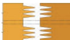
Si distingue tra due gruppi di sollecitazione I e II, che richiedono ancora determinate giunzioni scanalate. Nel profilo delle giunzioni fattori quali il grado di indebolimento, la lunghezza delle giunzioni e l'angolo di pressione dipendono reciprocamente.
