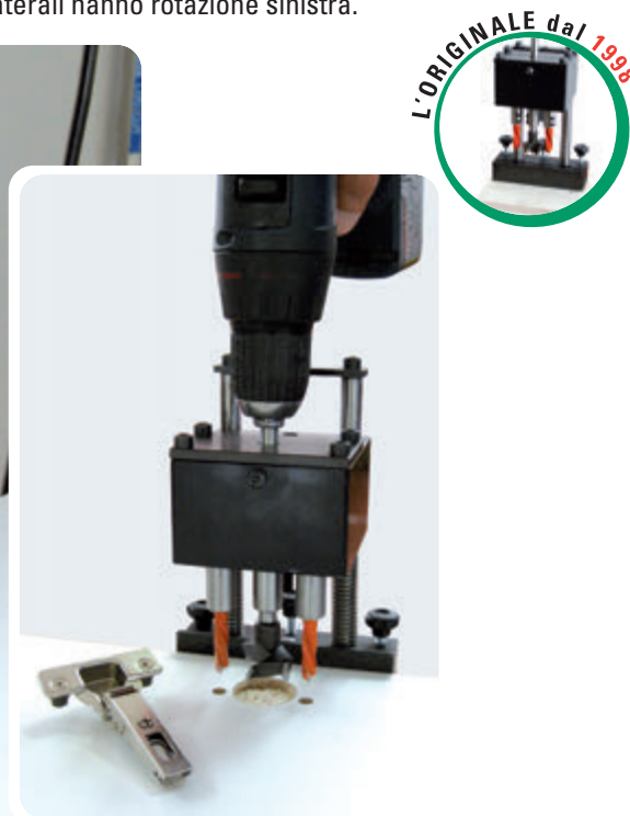
TRIMATIC 48/6 utilizzato con trapano portatile
