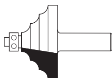
FRESE HW A TRIPLO RAGGIO CONCAVO Z=2 Pag. 2.16
